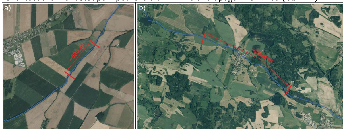
Obr. 24: Vymezení hodnoceného úseku v případě dvou různých toků s podobnou šířkou koryta (do 8 m), (a) napřímený vodní tok v kulturní krajině se stejnorodými morfologickými parametry koryta – možnost vymezit kratší hodnocený úsek; (b) vodní tok protékající mozaikovitou krajinou – nutnost vymezit delší hodnocený úsek
