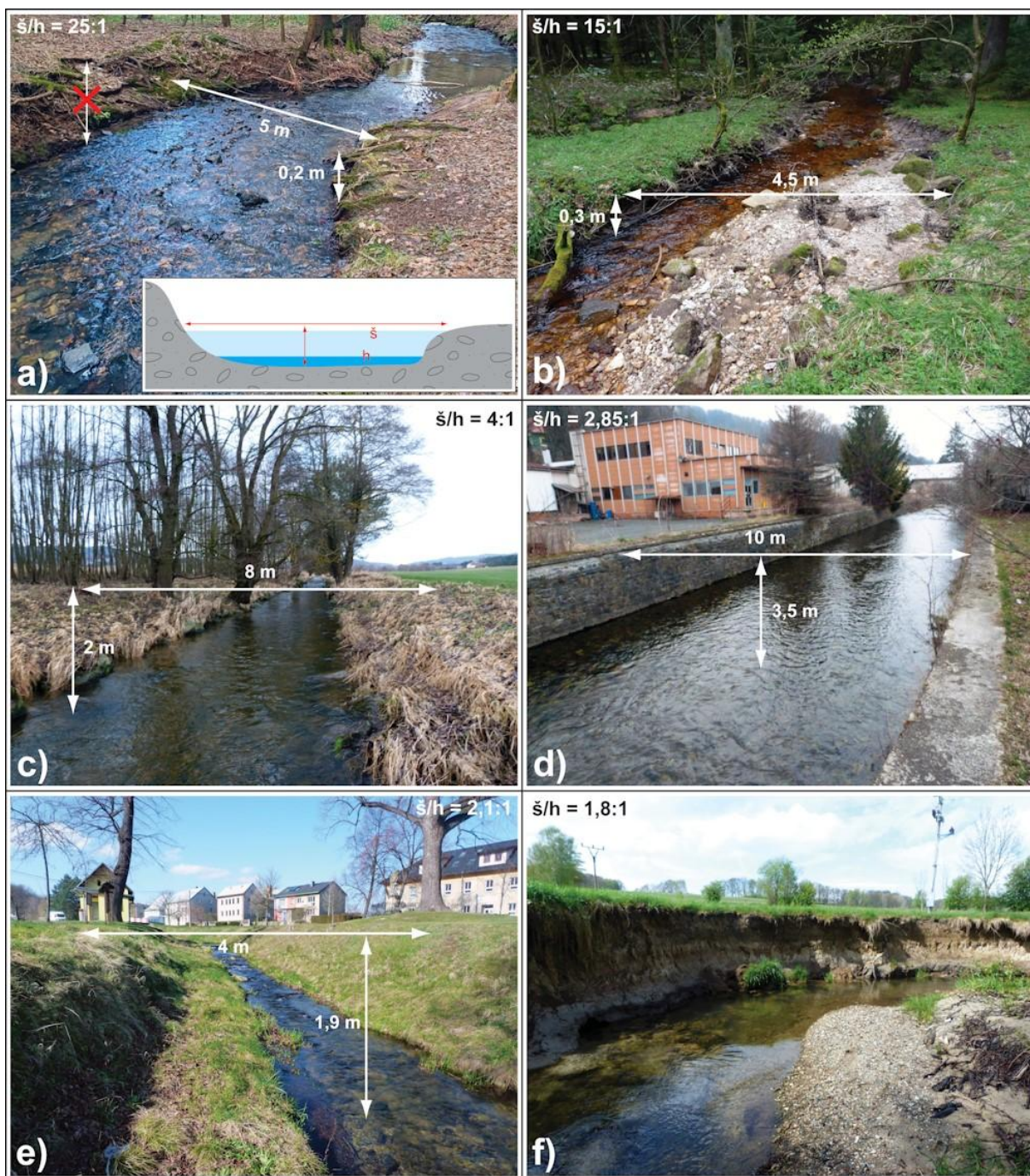
Obr. 42: Konkrétní příklady vodních toků s rozdílným indexem zahloubení, (a) přirozené koryto s nízkým zahloubením (kategorie 1), hloubka koryta se měří dle nižšího z břehů; (b) přirozené koryto s nízkým zahloubením (kategorie 1), šířka i hloubka koryta se měří od břehové hrany; (c) středně zahloubené, regulované koryto (kategorie 2); (d, e) upravené koryto s vysokým zahloubením (kategorie 3); (f) koryto bez úprav s probíhajícím zahlubováním (kategorie 3)
